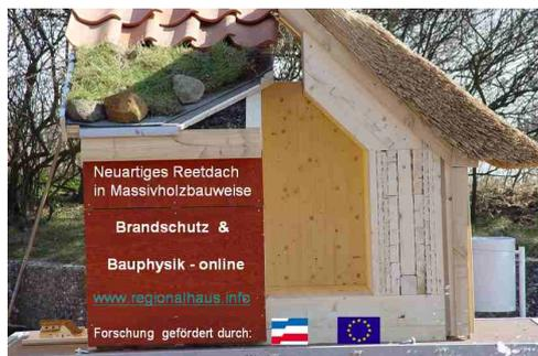
kann man die Brennbarkeit erheblich reduzieren. Tests in der Materialprüfanstalt in Braunschweig ergaben, dass die vorgeschlagene Dachkonstruktion anstelle der gedachten F30 (Feuerwiderstand für
