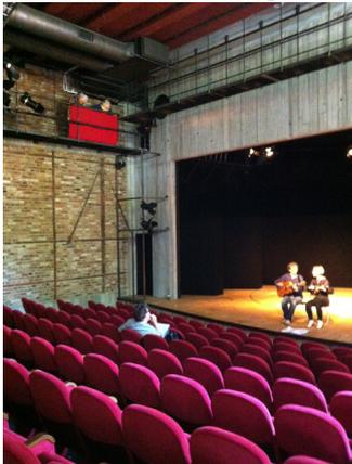
gestellten Schalelementen eine schallschluckende Oberfläche erhielt. Die Wand des Theatersaals ist leicht gerundet und aus gebrannten Steinen mit offenen Fugen gesetzt, ebenfalls wegen der besseren Akustik. Wie zufällig leitet der leichte Schwung der Wand den Zuschauer in den Raum hinein. Dort hat man von jedem Sitz einen sehr guten Blick auf die vielseitig nutzbare Bühne.
